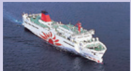
さんふらわあ しれとこ 総トン数:11,410トン 航海速度:25ノット 全長:190m 旅客定員:154名 車両搭載数:乗用車62台/大型トラック160台
