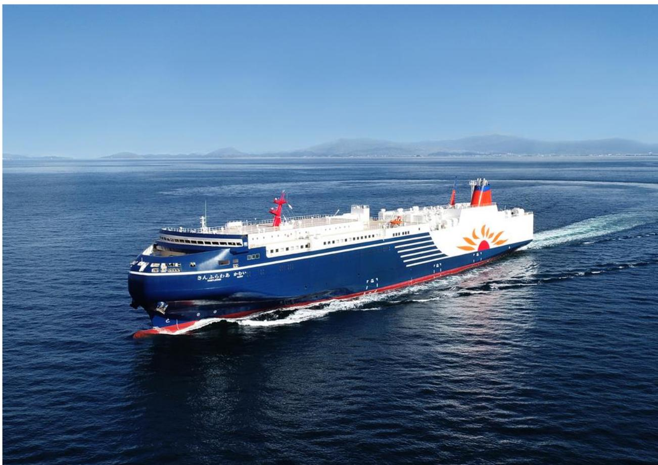
本船は、日本で 3 番目の LNG(液化天然ガス)を主燃料として運航する長距離フェリーで、航行時の風圧を低減する最新の船型を取り入れ、環境負荷の大幅な低減を実現し、従来船比約 35% の CO<sub>2</sub>(二酸化炭素)排出量削減を実現します。
